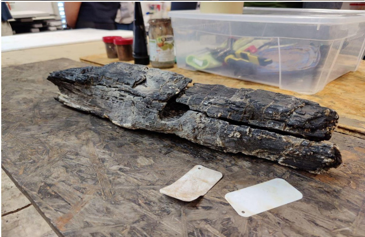
Fotos aus dem Holzrestaurationslabor, mit PEG konserviertes Holzstück (Fotos: Heiko Heese)
