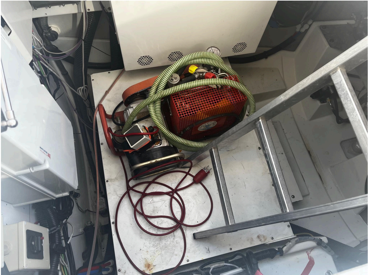
Und unser 3. Kompressor: ein Coltri Elektro mit 70l/m. © Segeltaucher
