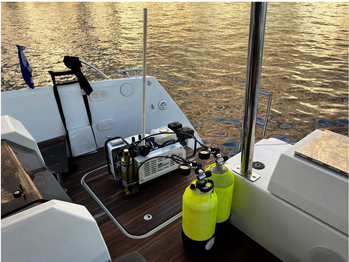
Einer von 3 Kompressoren - hier ein Bavaria 150l/min Benzin Kompressor © Segeltaucher
